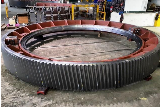
Figure 5 : exemples d'application pour les fontes GS à matrice ferritique renforcée : couronne
