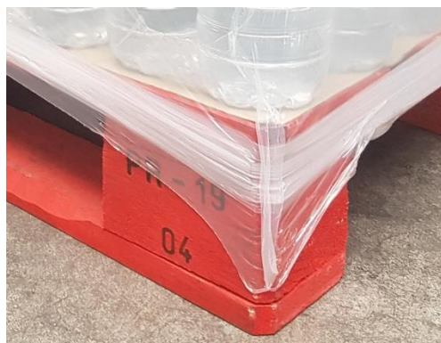
Thermoscellage du film sur un bandeau de serrage directement sur la palette.
