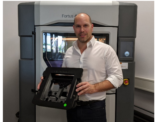
Stefan Kammann devant l'imprimante 3D Fortus 450mc du centre de compétence ADaM, tenant un gabarit de collage imprimé en 3D conforme à la norme ESD
