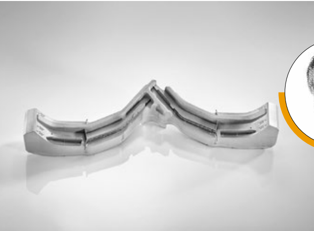
Élément de garniture du moule pour la fabrication du pneu CrossClimate.
