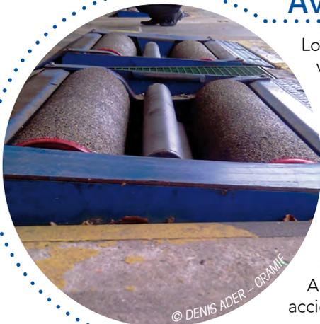
Lors des contrôles techniques sur les poids lourds, ces véhicules sont passés sur des bancs à rouleaux appelés "freinomètres", lesquels entraînent les roues et les essieux lors de l'essai des freins.
