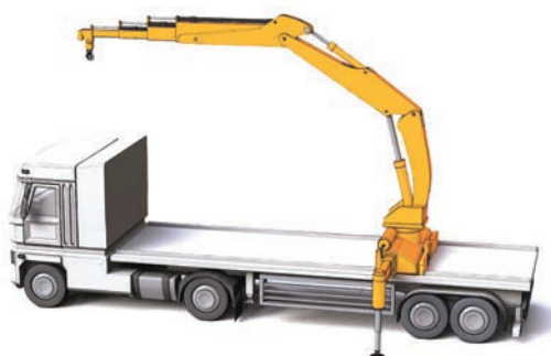
Grue de chargement montée en position centrale
