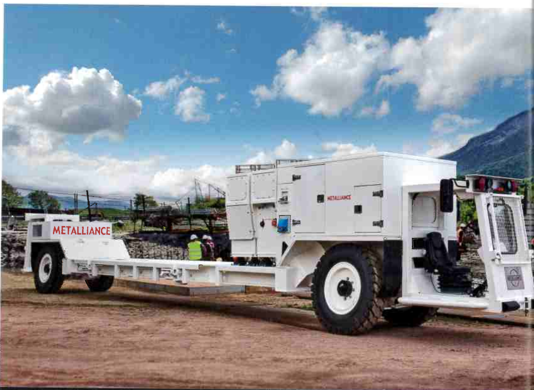
Engin d'approvisionnement de tunnelier fonctionnant sur batteries électriques.
